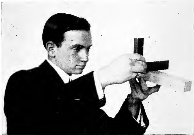
Fig. 25—Testing from Edge to Edge
